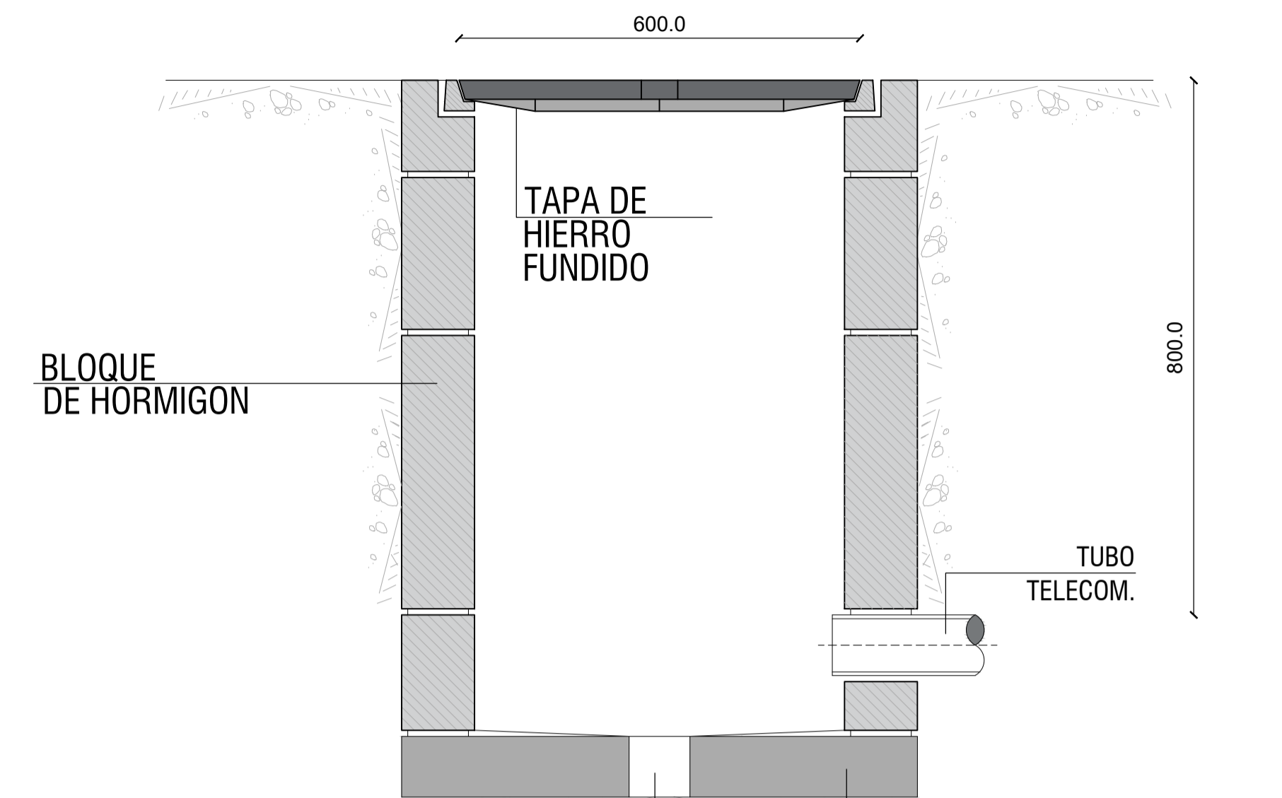
3 DETALLE CÁMARA DE PASO S/E
